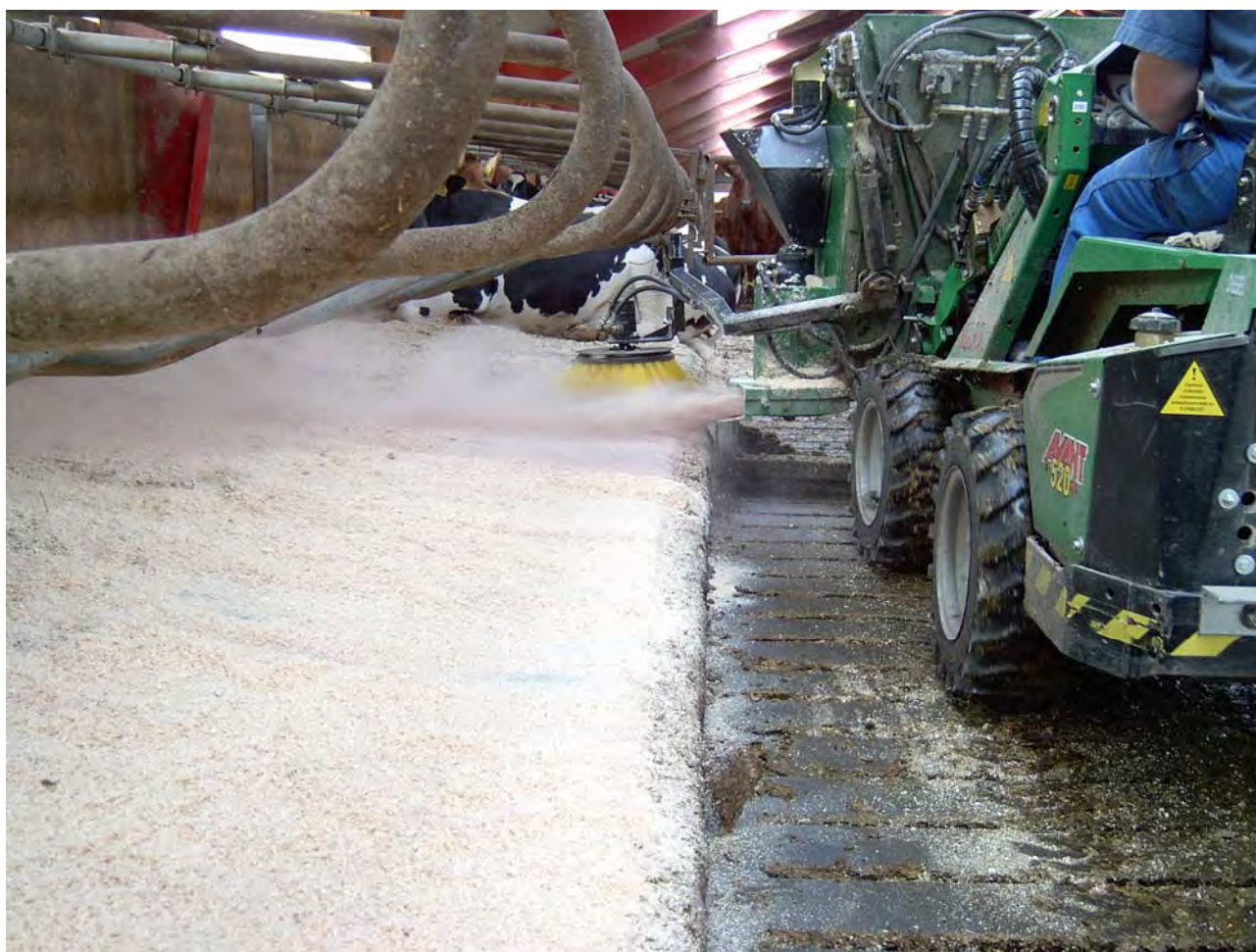
Strømaskinen med Stalosan doseringsanlæg. Lejet fejes, bagkant samt spalter skræbes, og der strøs spåner og Stalosan. Alt sammen i én arbejdsgang.
